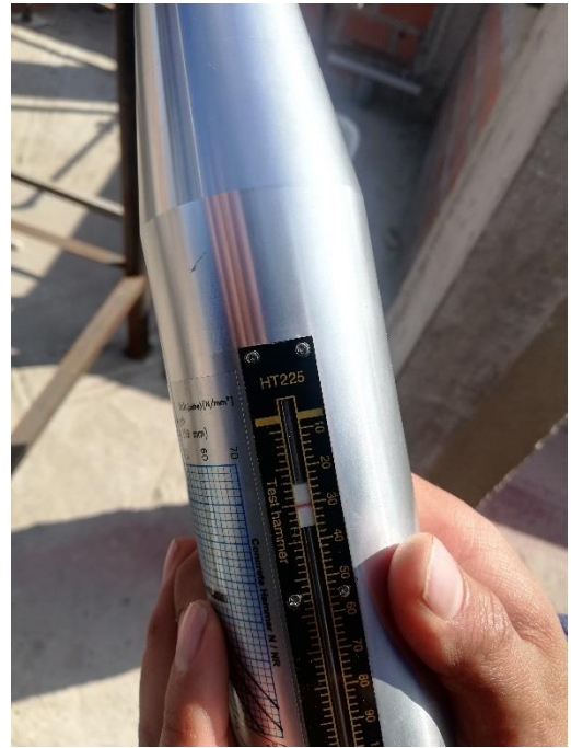
Fotografía N° 03: Ensayo de esclerómetro en 90° y posterior lectura
