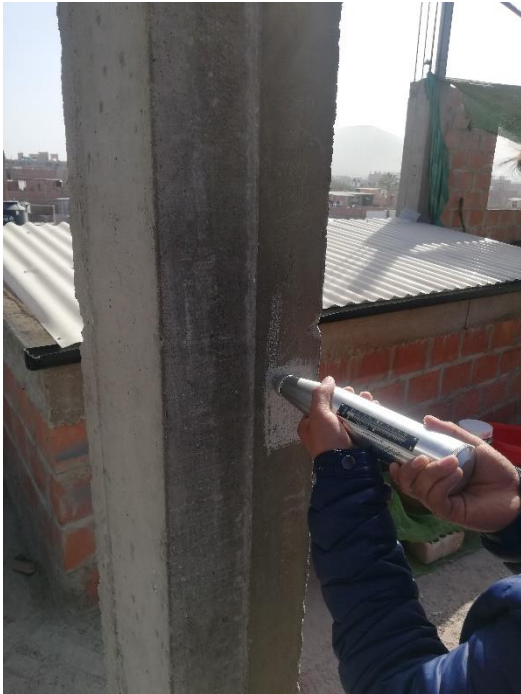
Fotografía N° 03: Ensayo de esclerómetro en 90° y posterior lectura
