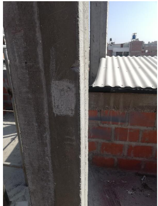
Fotografía N° 02: Se tomaron 8 puntos de cada elemento, distanciados a 1"
