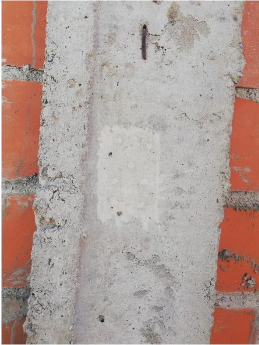
Fotografía N° 01: Ensayo de esclerometria en columnas.
