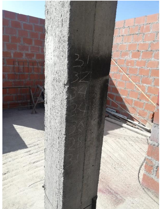
Fotografía N° 01: Ensayo de esclerometria en columnas.
