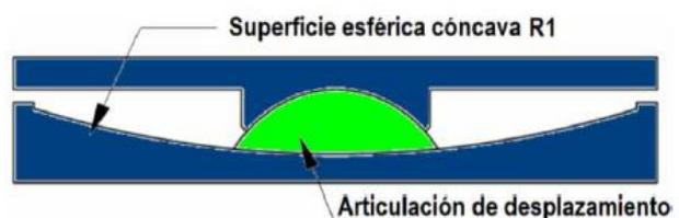
Figura 2.13. Aislador Péndulo de Fricción – *Friction pendulum (FP)*.
